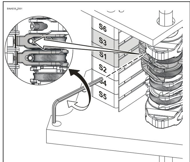
Der Endschalter NOT AUF S1 ist durch die Einstellung der Endlage AUF voreingestellt. Bei falscher Drehrichtung oder Versagen des Endschalters AUF S3 muss das Tor risikolos anhalten. Gegebenenfalls den Schaltpunkt des Endschalters über die Feineinstellung korrigieren.
