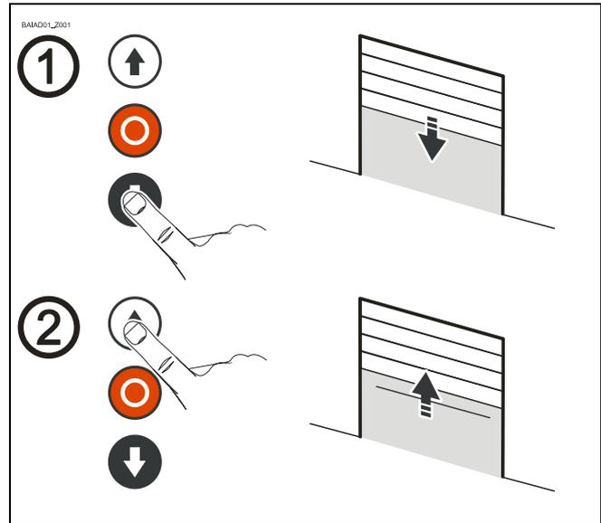
Die Endlage AUF kann durch die Feineinstellung korrigiert werden. Nach einer Korrektur die Torposition prüfen.
