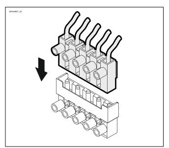
• Insert the limit switch plug.
