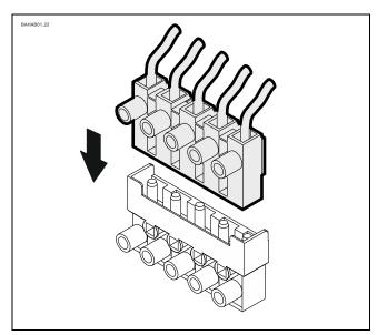
• Insert the limit switch plug.
