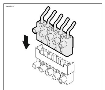
• Insert the limit switch plug.
