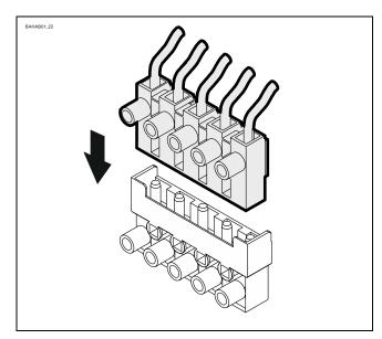
• Insert the limit switch plug.
