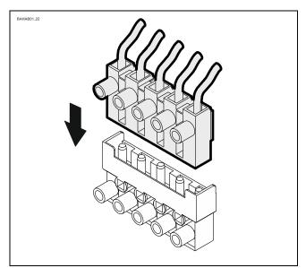
• Insert the limit switch plug.
