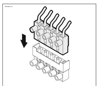
• Insert the limit switch plug.
